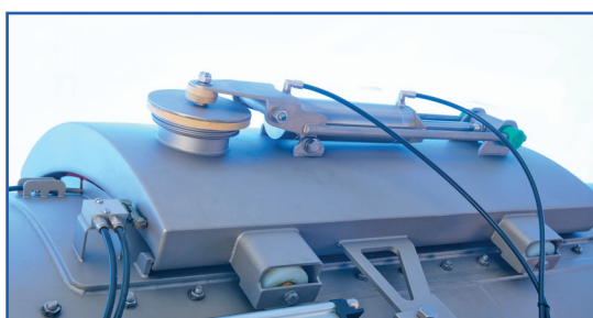
Vanne de porte fermée
