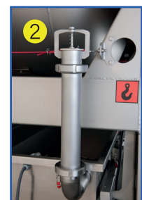
Scarico vasca di raccolta mosto
